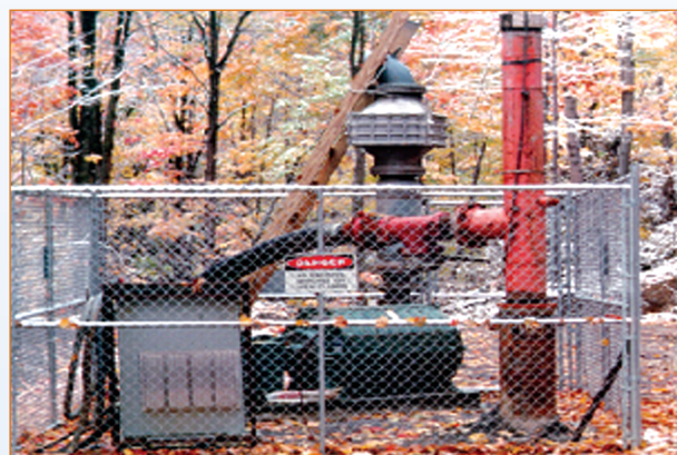
Figura 2: Un pozo de relleno utilizado para extraer MMC de venas de carbón colapsadas después de haber sido minadas.
