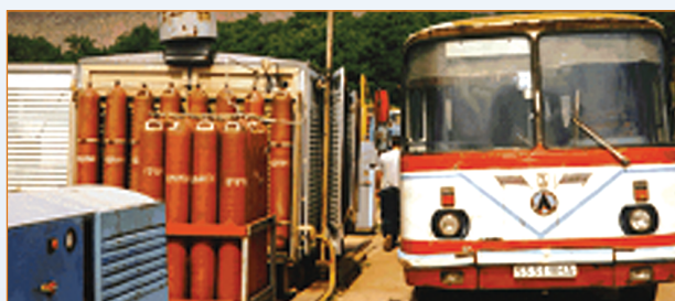
Figura 3: Emisiones de metano de minas de carbón (MMC) mientras carga combustible en Ucrania.
